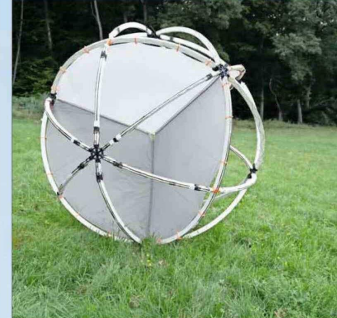
El primer prototipo del rover Tumbleweed. La versión que será probada en Atacama corresponde a una evolución de este diseño, desarrollada para evaluar su desempeño en pruebas de campo.
