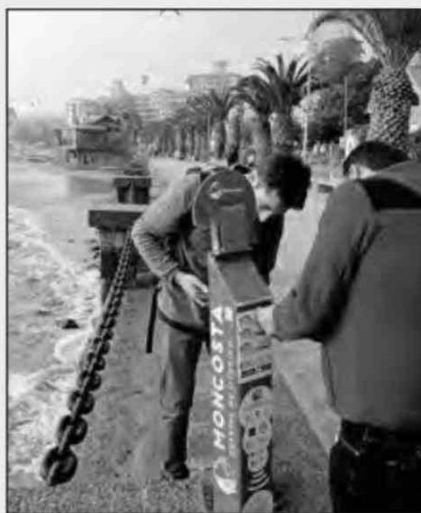
En la Playa Chica de Papudo se instaló el tótem que permite la toma y envío de fotografías para efectuar las mediciones.
