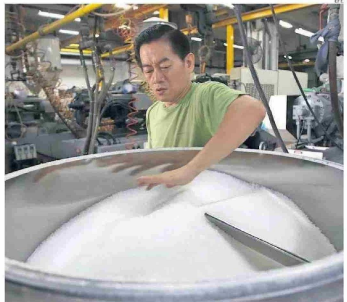
TRABAJADOR PREPARA POLIPROPILENO O RESINA PLÁSTICA, MATERIA PRIMA DE LOS CONTENEDORES PLÁSTICOS.
