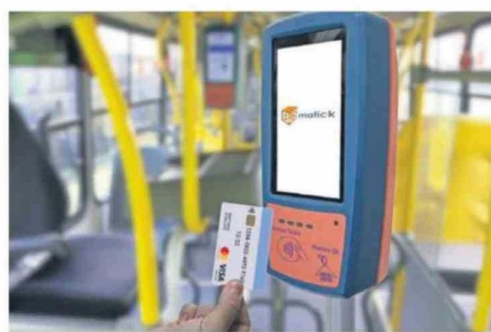
Para pagar se acerca el chip de la tarjeta al sensor del validador.
