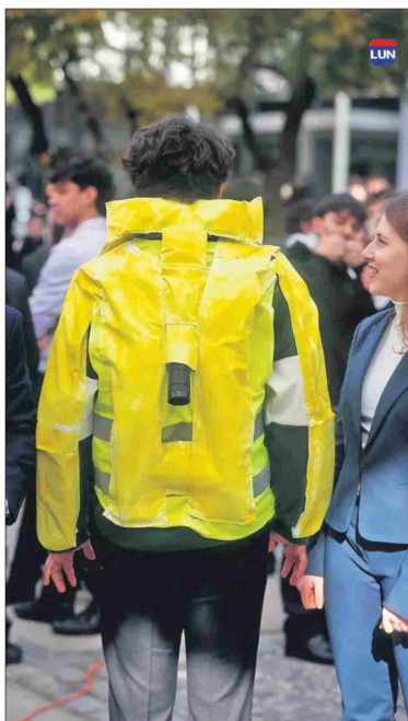
Este chaleco incluye un acelerómetro que detecta caídas de 1 a 4 metros de altura.
