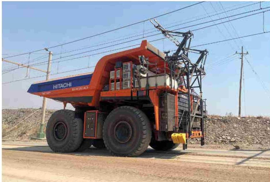
Zambia, África, del CAEX modelo EH4000AC-3, de 240 ton, que opera con baterías recargables, conectado a un sistema de *trolley*, lo que permite una carga dinámica del camión.
