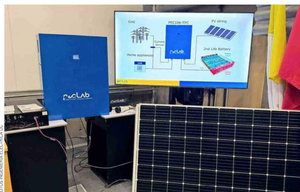
Es el primer inversor solar híbrido con almacenamiento de baterías de segunda vida.
