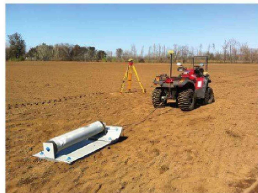
Figura 2. a) Unidad sensor electromagnético EM-38 + Sistema RTK para medición de topografía; b) Mapa de variabilidad CE de suelo c) mapa topográfico de suelo. (Fuente: INIA elaboración propia).
