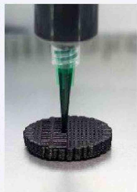
Electrodo impreso en rejilla contiene el hongo utilizado en el compartimento anódico de la pila. Foto: Empa.
