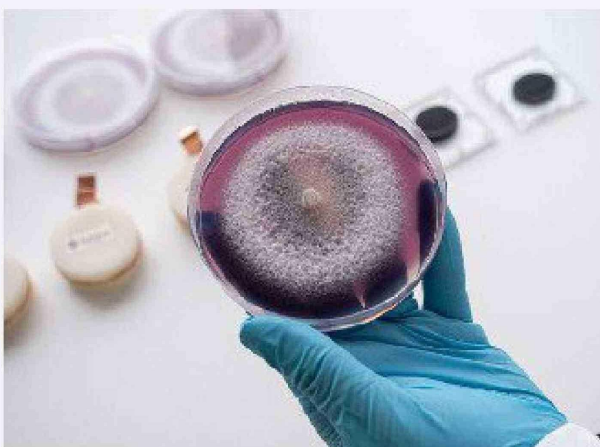
Crecimiento de los hongos (en primer plano) utilizados en la batería que necesita alimentación en lugar de cargarse. Foto: Empa
