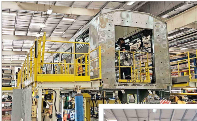
Los trenes son diseñados a medida, según los requerimientos de Metro; desde los colores hasta detalles como la instalación de puertos USB-C.
