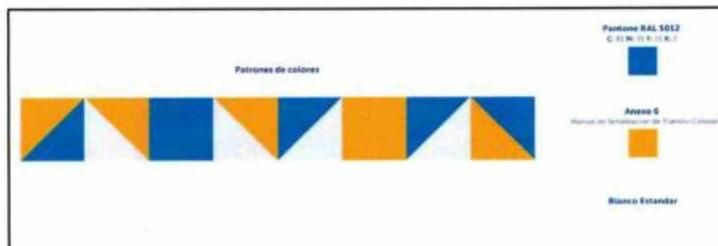
La demarcación se ejecutará con pintura acrílica de alto tráfico. Debe considerar un coeficiente de roce de a lo menos 0.40. para cumplir la seguridad mínima de dicho parámetro indicado en el Manual de Señalización de Tránsito.
