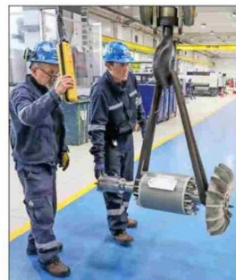
El motor eléctrico de una bomba de incendio de la fragata "Lynch" es otro fruto del centro.
