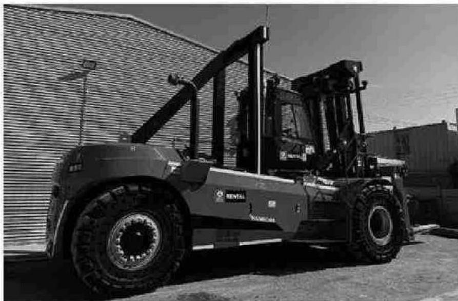
Entre sus características destacan su mástil doble para 4 metros de altura, cabina de visión total completamente suspendida (HCCS), motor diésel Tier 4F de bajas emisiones, joystick de mando, sistema antivuelco y estabilidad direccional mejorada. Está equipada con balizas, extintores, rejillas de protección y cámaras frontales y traseras. Dercomaq garantiza su mantenimiento y disponibilidad para proyectos de gran escala, asegurando operaciones más seguras y eficientes.
