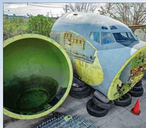
A la izquierda, el radomo que cubría el radar, cuyo alcance bordeaba los 400 kilómetros.
