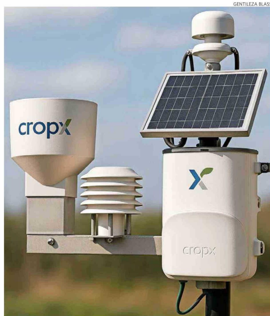
Estación Strato 1 mide temperaturas, humedad relativa, vientos y radiación.
