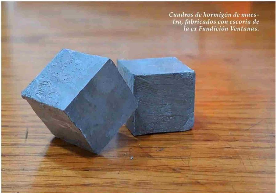
*Cuadros de hormigón de muestra, fabricados con escoria de la ex Fundición Ventanas.*
