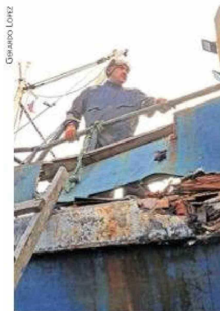
Las averías que recibió la lancha a motor a causa del impacto de la nave mayor.
