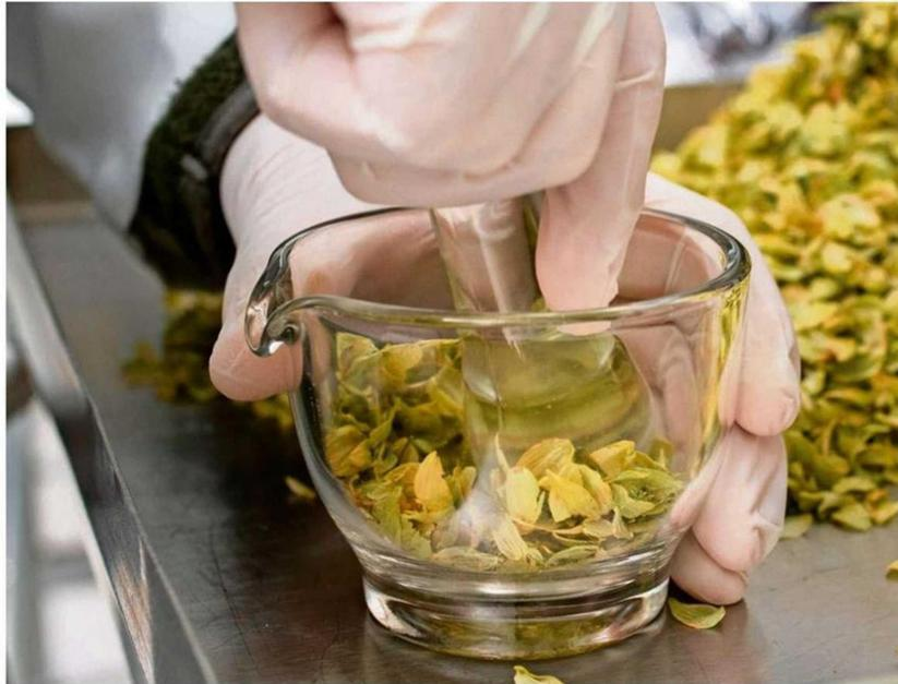
DESPUÉS DE MOLER LOS CONOS DE LÚPULO EN UN MORTERO, LOS INVESTIGADORES OBTIENEN UN EXTRACTO DE LÚPULO DEPOSITADO EN UN MATRAZ PARA SU CORRESPONDIENTE ANÁLISIS QUÍMICO CUANTITATIVO.
