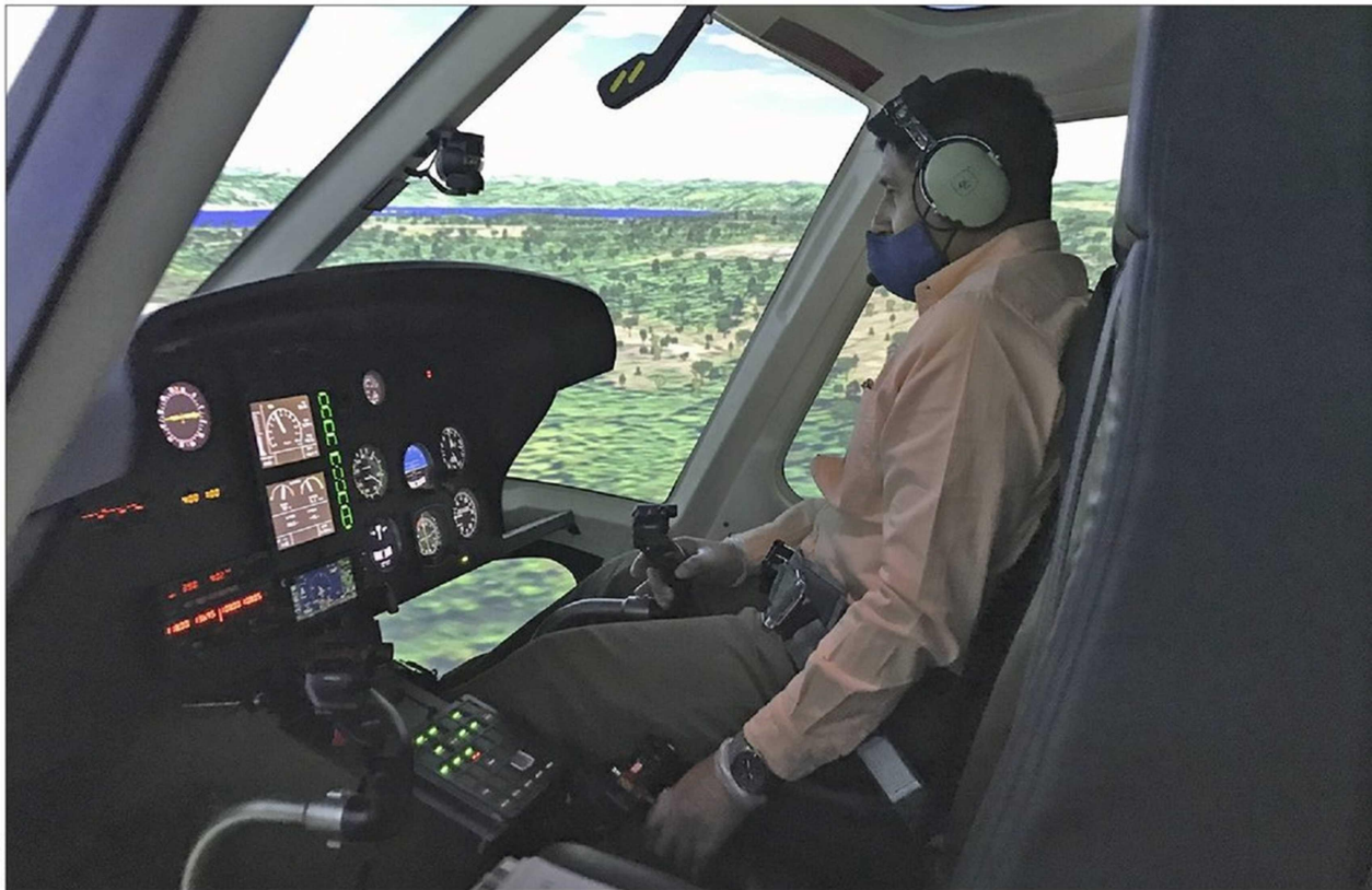
Un piloto ecuatoriano en el simulador del AS350 B3, el tipo de helicóptero más usado del mundo, en Ecotraining. Se puede ver una luz encendida en el panel de alarmas.
