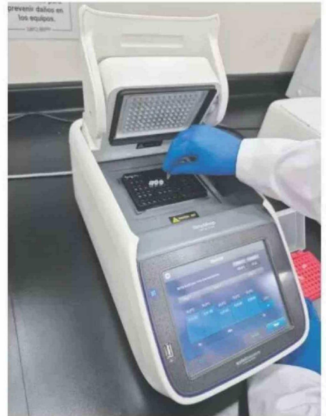
Muestras siendo cargadas en un termociclador para realizar la prueba de ADN de amplificación genética. / CORTESÍA USFQ
