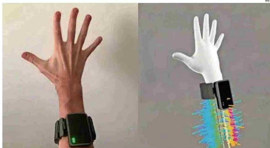
EL BRAZALETE ES ALTAMENTE SENSIBLE PARA DETECTAR LAS SEÑALES ELÉCTRICAS DE LOS MÚSCULOS.
