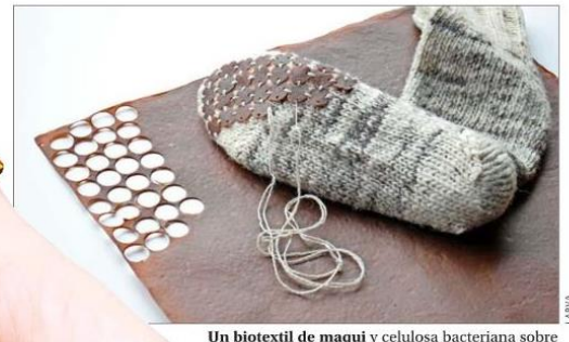
Un biotextil de maqui y celulosa bacteriana sobre soporte de lana, desarrollo colaborativo entre la diseñadora valdiviana Nury Lagos y Larva.
