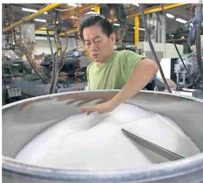
TRABAJADOR PREPARA POLIPROPILENO O RESINA PLÁSTICA, MATERIA PRIMA DE LOS CONTENEDORES PLÁSTICOS.
