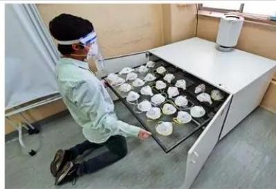
Uno de los primeros equipos de Lightwash, instalados en la ex Posta Central y el Hospital Sótero del Río, permiten desinfectar 60 mascarillas en 10 minutos con luz UVC.
